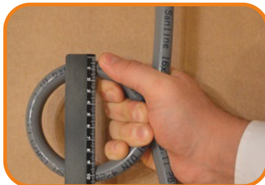
Отсутствие овализации и заломов. Радиус изгиба менее 4 диаметров трубы
