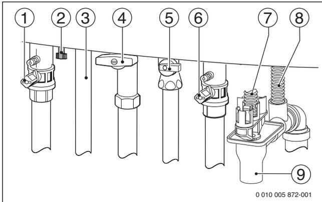
Рис. 1 Подключения газа и воды (дополнительная комплектация)
