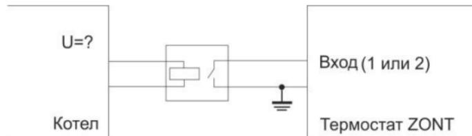
Сигнал «Авария» - напряжение ? В. Необходимо подключение к термостату через соответствующее реле
