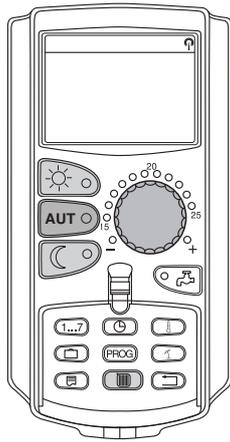
Можно выбрать режим приготовления горячей воды в баке.
