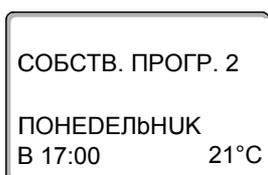
На экране появится следующее время включения. Измененная программа сохраняется под именем "СОБСТВ. ПРОГР. " с номером отопительного контура (здесь: "2").
