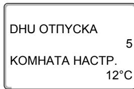
Удерживайте нажатой кнопку "Темп." и ручкой управления установите нужную температуру (здесь "12°C").
