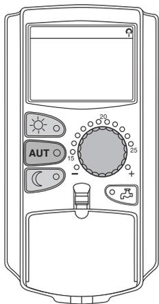
Комнатная температура задается ручкой управления при закрытой крышке. При открытой крышке нажмите дополнительно кнопку "Дневной режим" или "Ночной режим".
