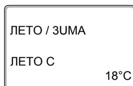
Удерживайте нажатой кнопку "Лето/зима". На экране на короткое время будет показан отопительный контур. Вращением ручки управления установите такую температуру переключения, ниже которой включается отопление (здесь: "18°C").
