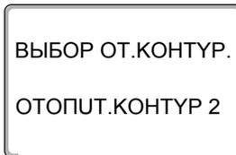
Отопительная установка может работать с несколькими отопительными контурами. Если нужно изменить параметры, например, в отопительной программе, то выберите сначала отопительный контур, для которого требуются изменения.
