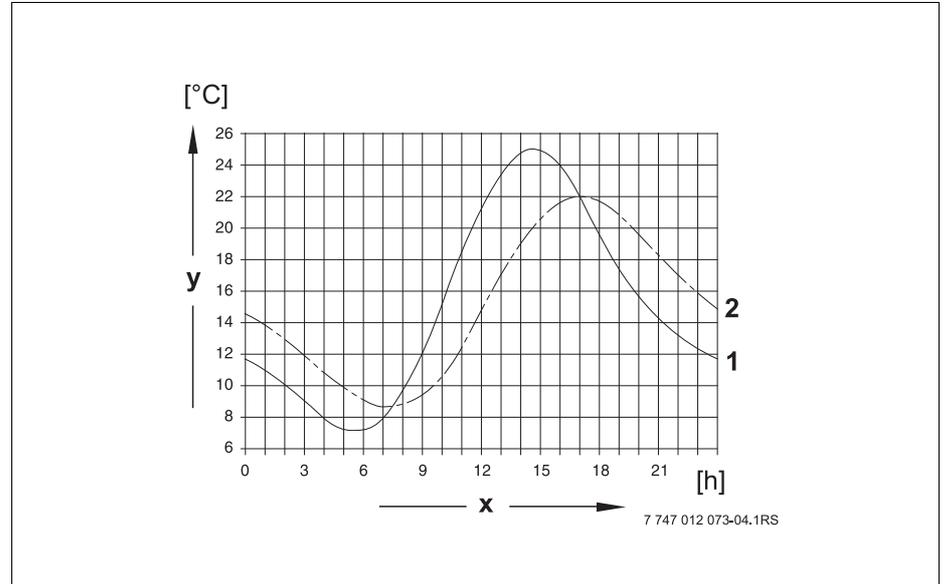
Рис. 15 Сравнение текущей и демпфированной температуры наружного воздуха
