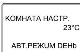
Теперь дневная комнатная температура установлена на 23 °С. После этого появится установленная постоянная индикация.
