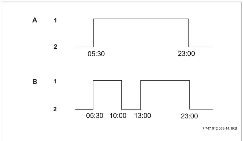
Рис. 16 Ввод точек переключения для прерывания периода отопления
