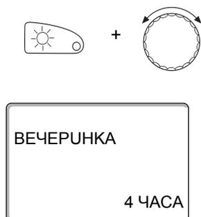
Удерживайте нажатой кнопку "Дневной режим" и **одновременно откройте крышку MEC2**. Функция "Вечеринка" включена. Удерживайте нажатой кнопку "Дневной режим" и ручкой управления установите нужное количество часов (здесь: "4").
