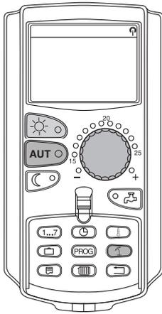
В системе управления переключение с летнего режима на зимний и наоборот происходит с некоторым запаздыванием по времени, так как сигнал от датчика наружной температуры поступает уже с учетом аккумулирующей способности здания и его теплоизоляции ("демпфированная наружная температура", → рис. 15).
