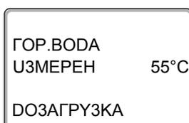
В зависимости от ёмкости бака и мощности котла приготовление горячей воды длится от 10 до 30 минут. У проточных и комбинированных водонагревателей горячая вода практически сразу поступает в систему ГВС.
