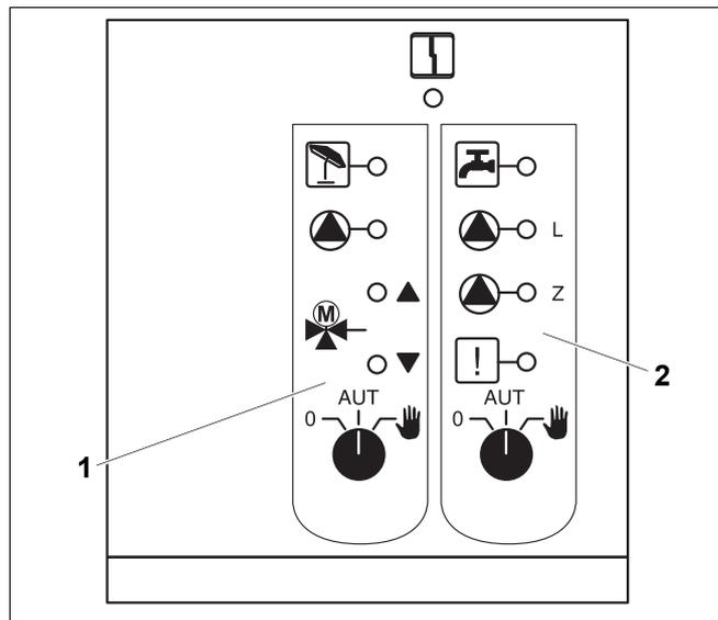
Рис. 22 Функциональный модуль FM441
