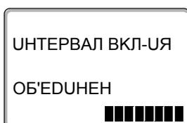
Когда выбрана точка включения следующего по времени отопительного периода, то в нижней строке появляются восемь ячеек, которые будут гаснуть слева направо с периодичностью в секунду. При исчезновении последней ячейки два отопительных периода будут объединены.
