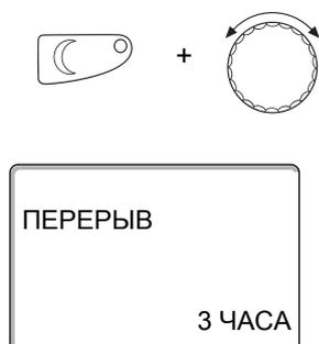
Удерживайте нажатой кнопку "Ночной режим" и **одновременно откройте крышку на MEC2**. Функция "Перерыв" включена. Продолжая удерживать кнопку "Ночной режим" нажатой, установите нужное количество часов (здесь: "3").
