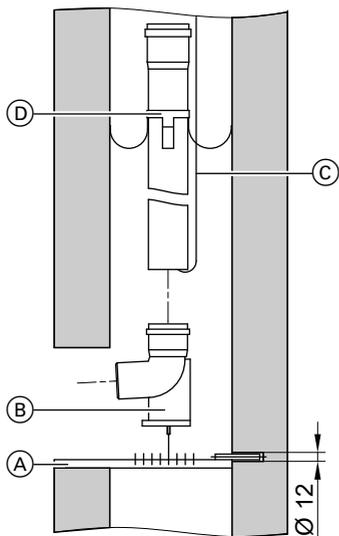
1. По центру задней стенки шахты дымохода просверлить отверстие  $\varnothing 12$  мм для крепления опорной шины (А).
