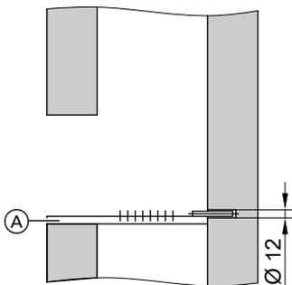
1. По центру задней стенки шахты дымохода просверлить отверстие  $\varnothing 12$  мм для крепления опорной шины (A).
