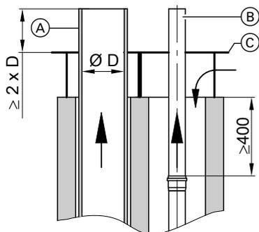
Крышка шахты в качестве общей отражательной плиты (шайба Майдингера) должна быть предоставлена заказчиком.
