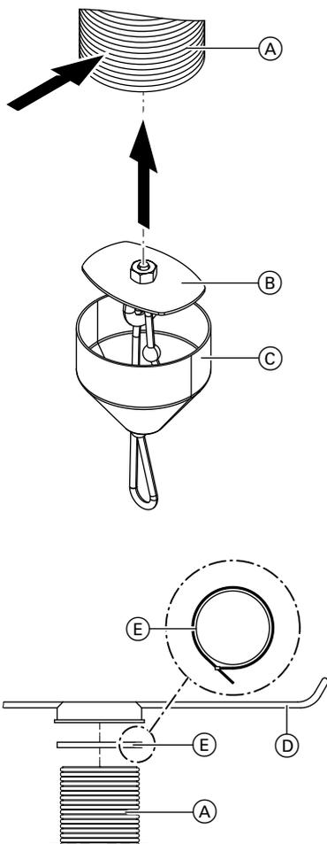
1. Слегка сдавить конец гибкого дымохода (А) для придания ему овальной формы. Вставить пластину (В) вспомогательного приспособления в третий паз дымохода.
