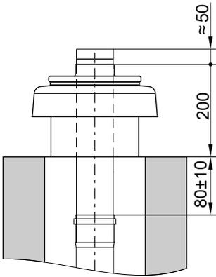
1. Верхняя труба должна заканчиваться приблизительно на 80 мм ниже верхней кромки шахты.
